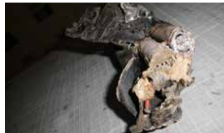
燃えた充電式電池
