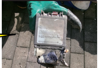
令和5年11月2日 火災の原因と思われるリチウムイオン電池
