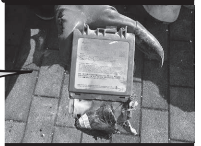
令和5年11月2日 火災の原因と思われるリチウムイオン電池
