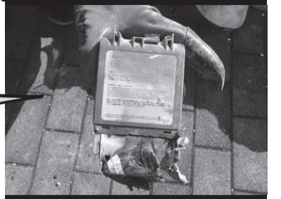
令和5年11月2日 火災の原因と思われるリチウムイオン電池
