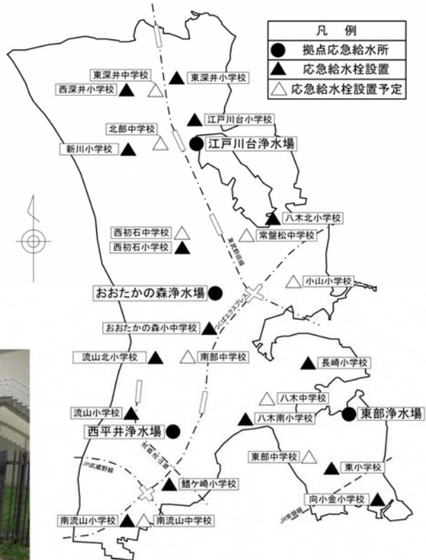
図 1 市内の応急給水所配置図
