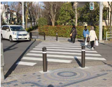
車止めを設置した交差点
