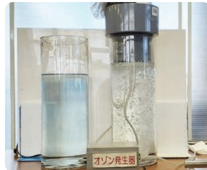
▲オゾン発生器を使った実験も行いました。 オゾンの力で、臭いなどを分解できます。
