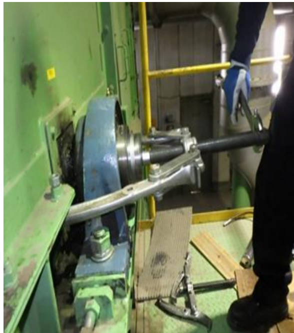
2次破砕機補修、篩選別機軸受交換補修
