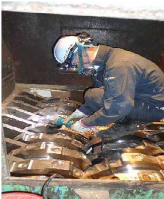
2次破砕機補修、篩選別機軸受交換補修
