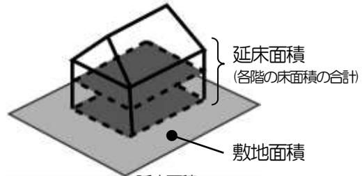
$$\text{容積率(\%)} = \frac{\text{延床面積}}{\text{敷地面積}} \times 100$$
