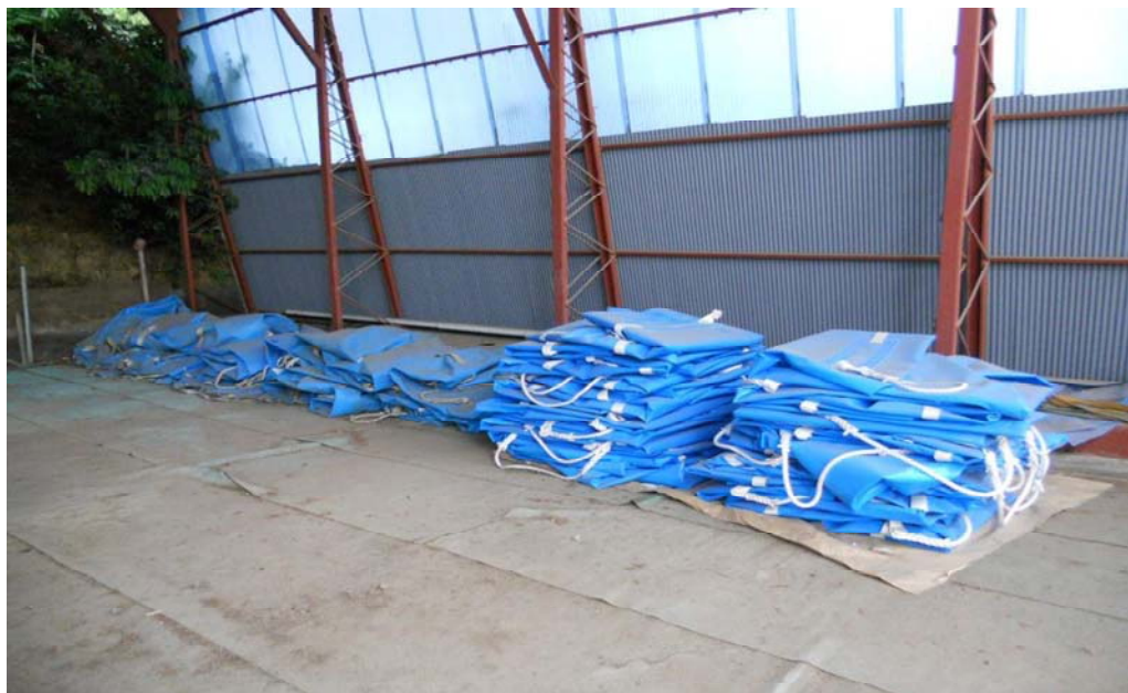
使用後の汚泥収納袋
