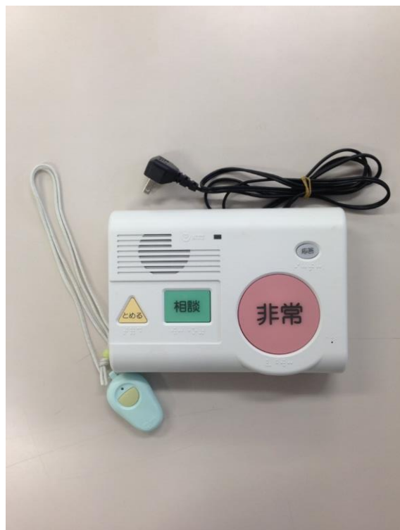
設置した緊急通報装置
