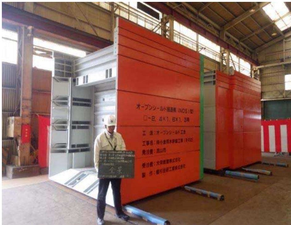
市道部工事に使うオープンシールドマシン
