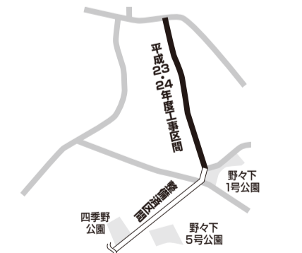
野々下1号雨水幹線は、道路の下を推進工法で施工
