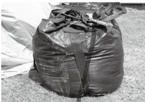
土を入れる大型土のう
