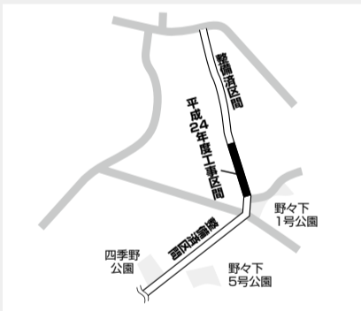
野々下1号雨水幹線は、道路の下を推進工法で施工
