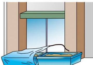
簡易水のうを作り、長めの板等と組み合わせ利用し、浸水を防ぎます。
