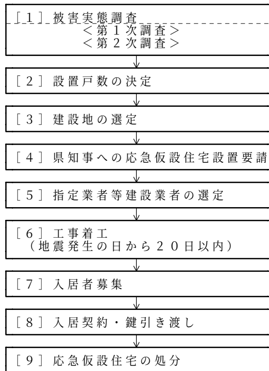
図 応急仮設住宅の建設フロー（災害救助法適用の場合）
