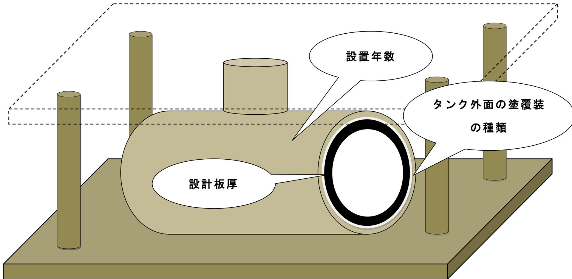
【地盤面下に直接埋設された鋼製一重殻地下貯蔵タンクの例】
