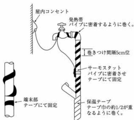
図Ⅱ-13-33 加温式凍結防止器
