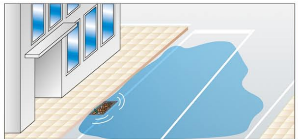
側溝や雨水ますにごみや落ち葉が詰まり道路が冠水
