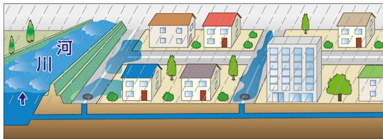
想定外雨量・河川からの逆流・雨水排水能力不足
