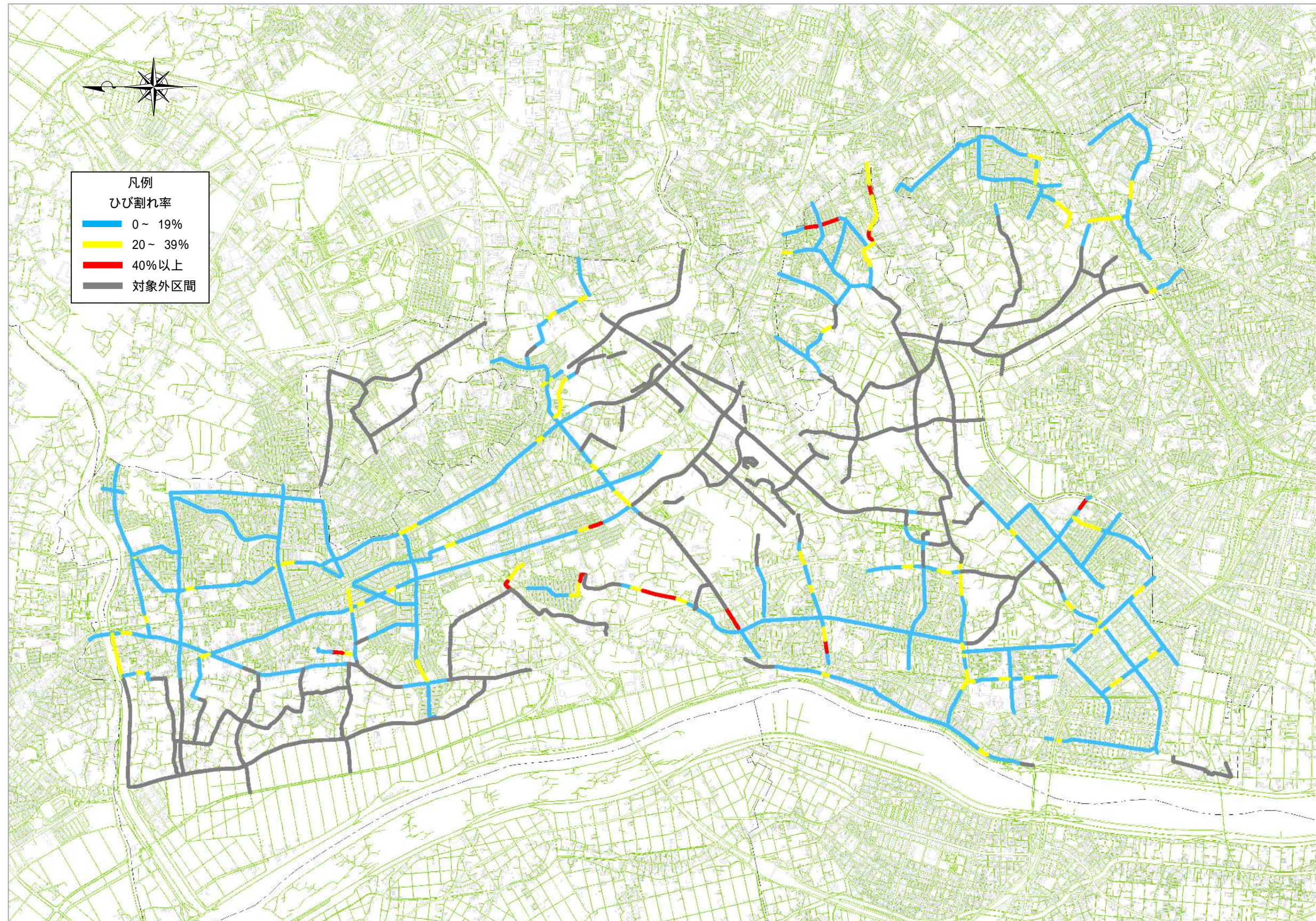
図 5-6 DID地区の該当区間(ひび割れ率を色分け) < 出典:流山市資料 >
