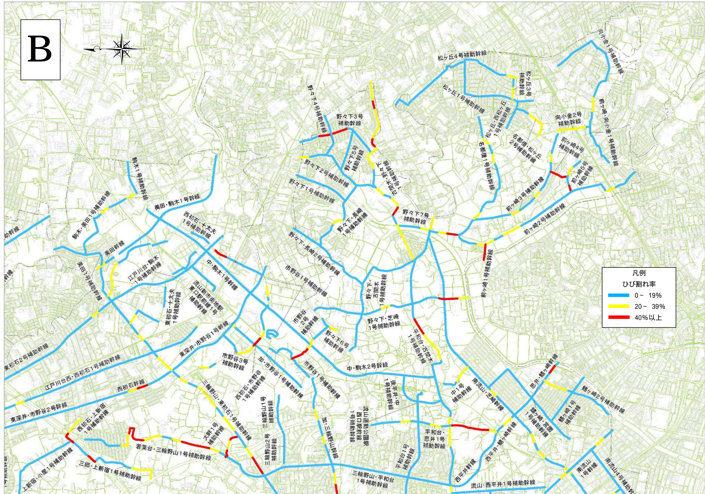
図 2-7 ひび割れ状況の分布図(B 拡大(南東部))
